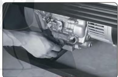
(b) Установите на место спускную пробку и залейте масло до верхней отметки по уровню крышки масляного бака.
