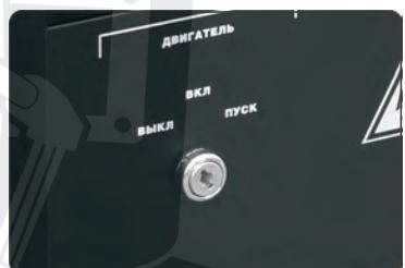
(c) Установите выключатель в положение «ВЫКЛ».
