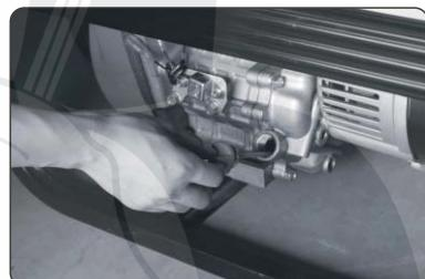
(б) Установите на место спускную пробку и залейте масло до верхней отметки по уровню крышки масляного бака.
