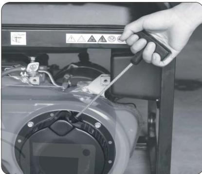
(e) После запуска двигателя, плавно верните рычаг дроссельной заслонки в положение «ОТКРЫТО».
